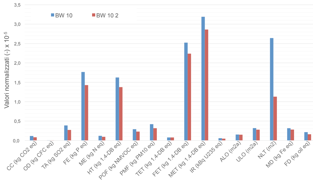
Grafico 1 - Risultati dell'analisi del ciclo di vita delle caldaie BW10 e BW10 2. Gli istogrammi mostrano gli impatti sulle singole sottocategorie di danno previste dal metodo ReCiPe Midpoint (con l'esclusione delle sottocategorie OD e WD che presentano impatti trascurabili)
