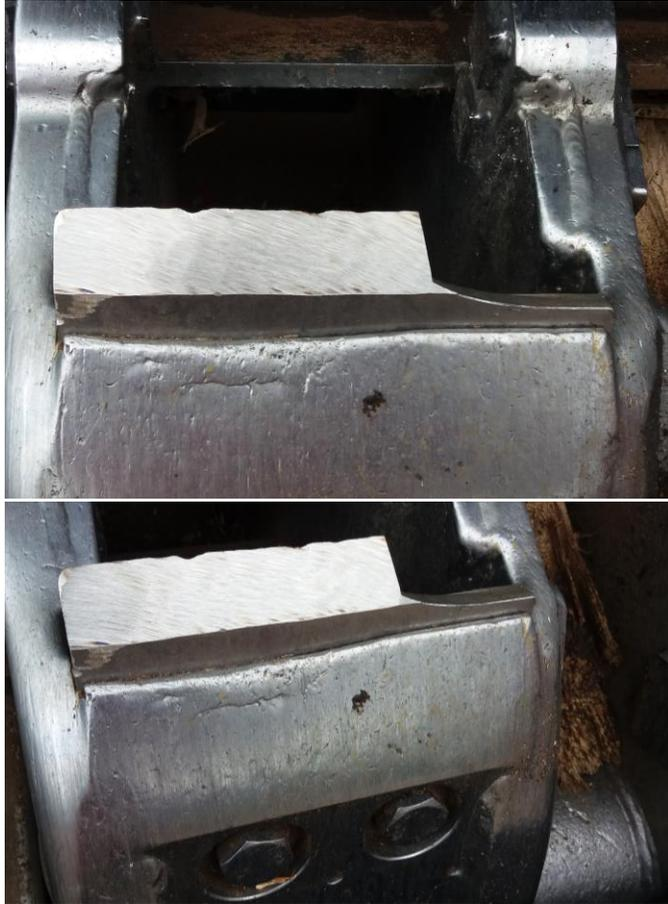
Per la produzione di cippato di qualità è necessario utilizzare cippatrici a tamburo a coltelli. I coltelli devono essere costantemente affilati e sostituiti in relazione all'utilizzazione della macchina
