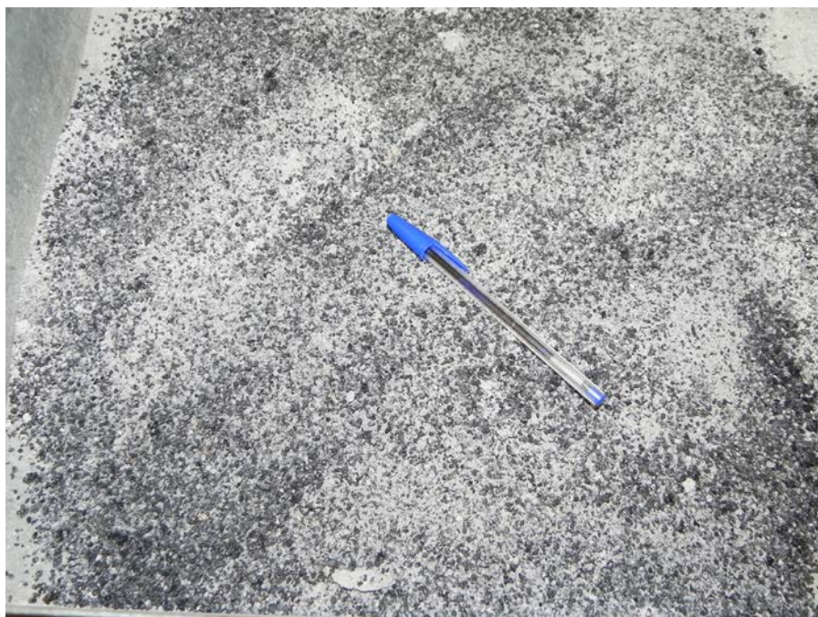
Scatola di raccolta delle ceneri in seguito a test con noccioli di oliva eseguiti su caldaia 1 (fonte: Mediaville et al.2018)
