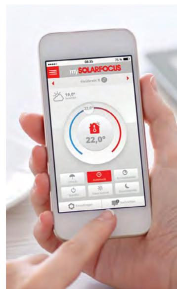
Inoltre, con l'applicazione **mySOLARFOCUS** possono essere gestiti e monitorati dall'utente le funzioni e i parametri energetici dell'impianto di riscaldamento. In combinazione con la funzione meteo si può impostare l'impianto sullo smartphone, ottimizzando il funzionamento degli impianti ibridi in modo predittivo. Ad esempio, se l'impianto ibrido è dotato di un impianto solare termico, in funzione delle previsioni del tempo viene data priorità al solare e la caldaia rimane spenta. ●
